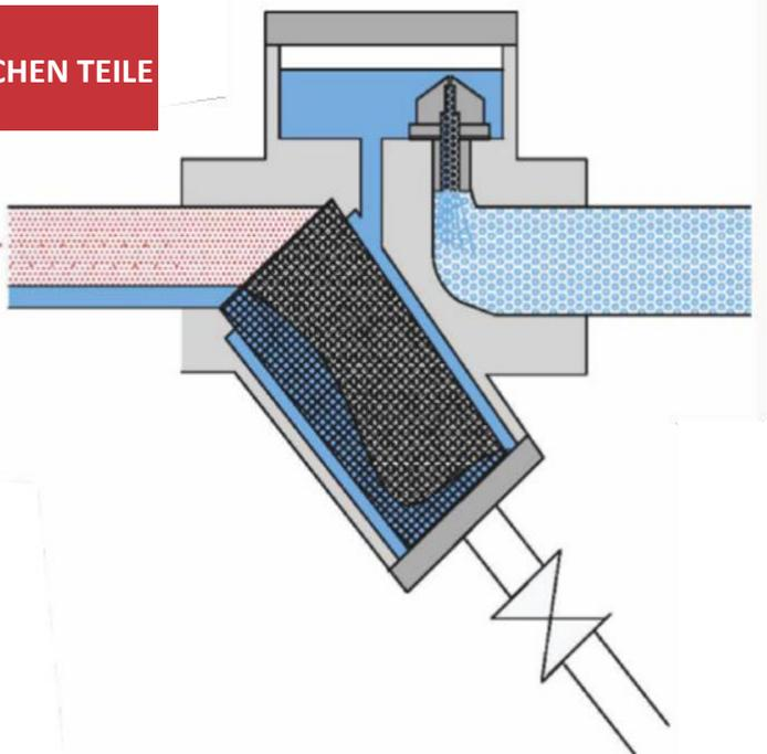
**DAMPF KANN DIE KONDENSAT-SPERRE NICHT ÜBERWINDEN**
